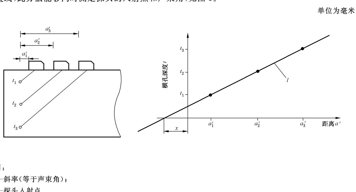
图 1 同时测定探头入射点和声束角的图示法
